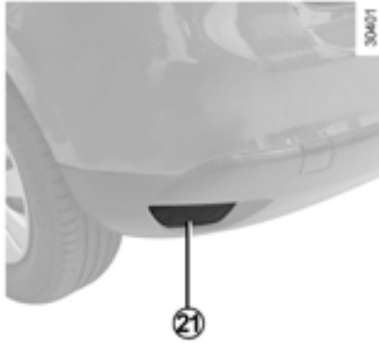
مدل پنج درب چراغ مه شکن عقب 21 نگه دارنده لامپ را به وسیله‌ی چرخاندن آن به سمت مرکز خودرو باز نمایید، دسترسی به آن از زیر خودرو امکان‌پذیر است. نوع لامپ: P21W
